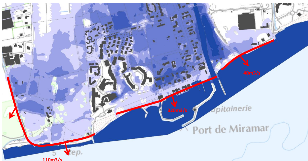
Figure 17 : Extrait cartographique de l'écoulement des eaux sur la frange littorale (pour une crue d'occurrence Janvier 2014)
